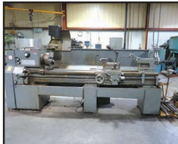
LEBLOND 11E 20x76 Engine Lathe
